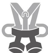
El arnés de asiento es un elemento textil. Envuelto alrededor de la cintura, conectado a cada pierna y equipado con un punto de fijación ventral, permitiendo la suspensión de una persona.
