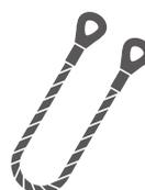
Los elementos de amarre pueden estar constituidos por un absorbedor de energía. Estos elemento permite amortiguar el choque en caso de caída. Este elemento está cubierto por la norma EN 355.
